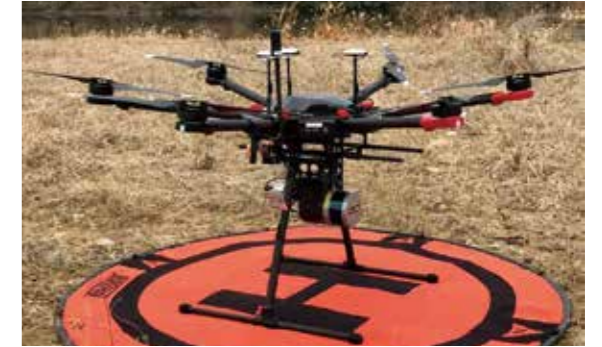
調査で使ったUAV。GPSアンテナ、カメラ、レーザー装置が搭載されている。
