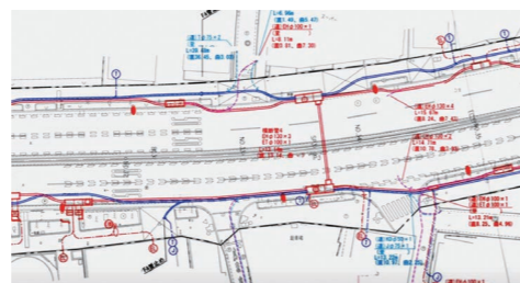
既存の埋設物と干渉すると修正作業が発生する。
